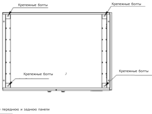
Рис. 3-7: Схема расположения отверстий под винты на шкафу и поддоне
