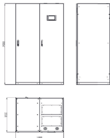
Рис. 2-3 Размеры шкафа ИБП 600 кВА (единица измерения: мм)
