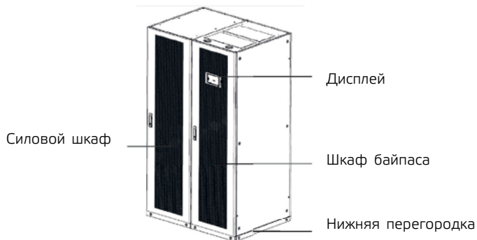
Рис. 1-3 Внешний вид ИБП мощностью 600 кВА
