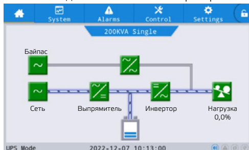
Рис. 4-4: Схема потоков энергии выпрямителя и инвертора во время работы
