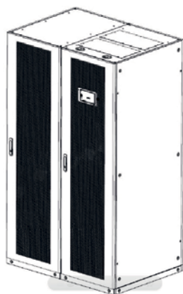
Рис. 2-15 Снятие крышки распределения питания и верхних заглушек
