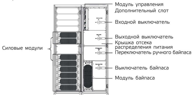
Рис. 1-9 Структура ИБП 400 кВА (полная конфигурация)
