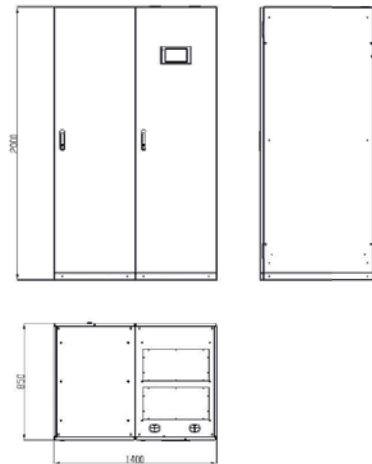
Рис. 2-3 Размеры шкафа ИБП 600 кВА (единица измерения: мм)
