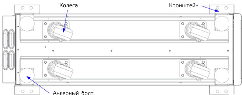
Рис. 3–1 Опорная конструкция (вид снизу)
