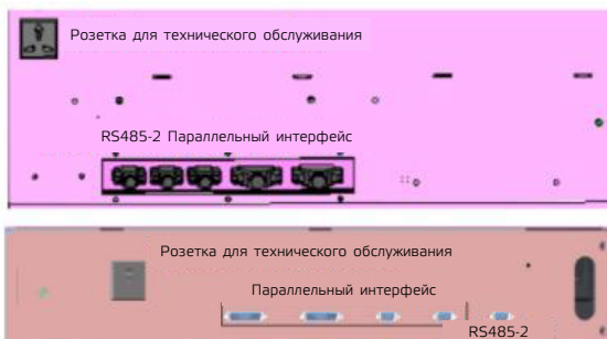
Рис. 3-41: Параллельный интерфейс на внутренней двери
