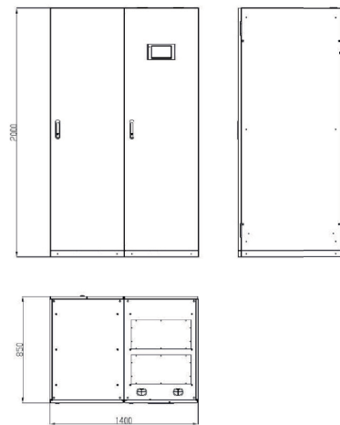
Рис. 2-3 Размеры шкафа ИБП 600 кВА (единица измерения: мм)
