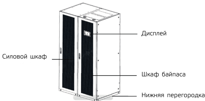
Рис. 1-2 Внешний вид ИБП мощностью 500 кВА
