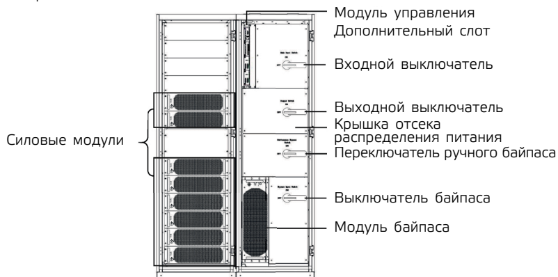
Рис. 1-9 Структура ИБП 400 кВА (полная конфигурация)
