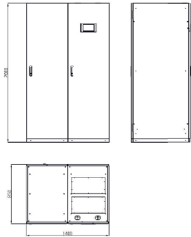
Рис. 2-3 Размеры шкафа ИБП 600 кВА (единица измерения: мм)
