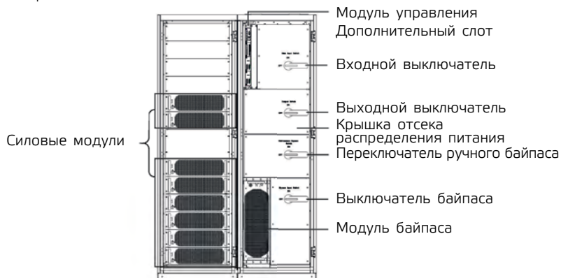
Рис. 1-9 Структура ИБП 400 кВА (полная конфигурация)
