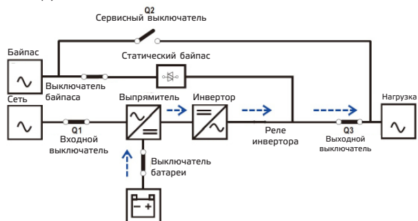
Рисунок 3-5 Диаграмма режима работы от аккумулятора
