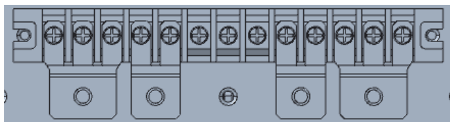
31 HV10K (L) / 15K (L) / 20K (L) и 31 LV 5K (L) / 7,5K (L) / 10K (L) схема замыкания клемм перемычками из листовой меди
