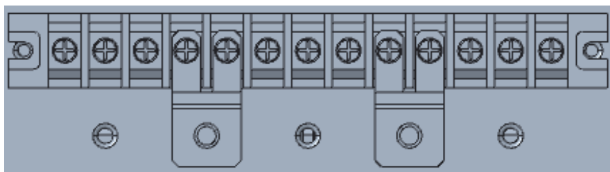
33 HV10K (L) / 15K (L) / 20K (L) и 33 LV 5K (L) / 7,5K (L) / 10K (L) схема замыкания клемм перемычками из листовой меди
