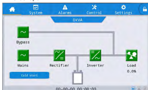
Рис. 5–1 Кнопка холодного старта на ЖК-дисплее
