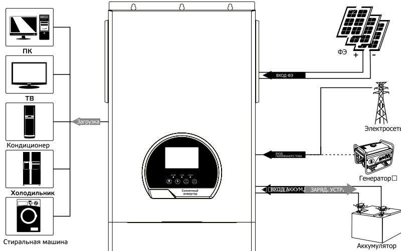
Рис. 1. Гибридная энергетическая система
