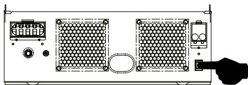
После правильной установки устройства и правильного подключения аккумулятора просто нажмите кнопку включения/ выключения (расположенную на корпусе), чтобы включить устройство.
