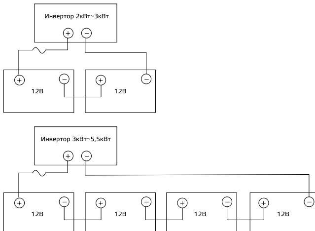
3. Вставьте кольцевую клемму кабеля аккумулятора в разъем аккумулятора инвертора и убедитесь, что болты затянуты с моментом 2-3 Нм. Убедитесь, что полярность аккумулятора и инвертора/зарядки подсоединенна правильно, а кольцевые клеммы плотно прикручены к клеммам аккумулятора.
