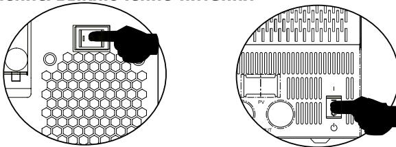
После правильной установки устройства и правильного подключения аккумулятора просто нажмите кнопку включения/ выключения (расположенную на корпусе), чтобы включить устройство.
