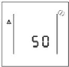
Горит красный светодиод ошибки, на LCD дисплее в области цифровой информации высвечивается код ошибки, а в области символов соответствующий значок ошибки , звучит непрерывный звуковой сигнал.
