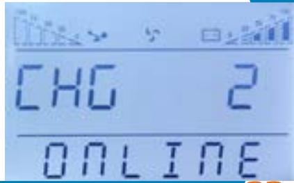
отображаются другие показания, необходимо произвести выбор нужного параметра. Для этого нажмите и удерживайте до звукового сигнала клавишу . При этом произойдет смена текущего параметра. Повторяйте нажатие до тех пор, пока на экране не будут отображены мигающие символы CHG.
