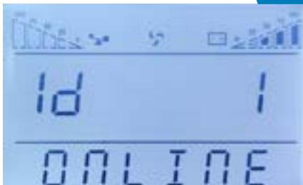
2. Символьное обозначение параметра ID – Id. Если на дисплее отображаются другие показания, необходимо произвести выбор нужного параметра. Для этого нажмите и удерживайте до звукового сигнала клавишу . При этом произойдет смена текущего параметра. Повторяйте нажатие до тех пор, пока на экране не будут отображены мигающие символы Id.
